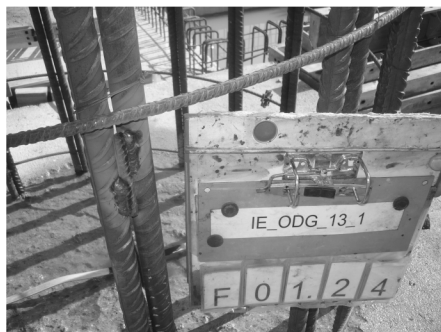
Rys. 6. Połączenie spawane pośrednie (z prętym I) dwóch prętów zbrojeniowych
