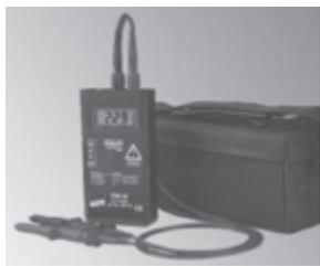
Rys. 11. Miernik PM 10 firmy DEHN do testowania ograniczników warystorowych klasy II (z przystawką do badania ograniczników na diodach Zenera do torów sygnałowych)
