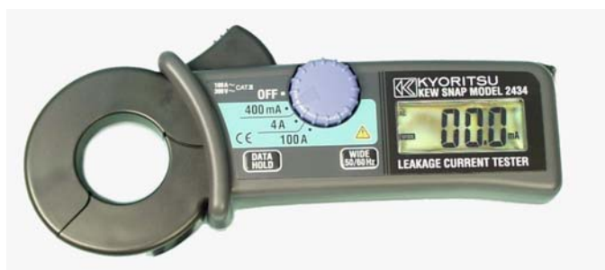
Rys. 12. Cęgowy miernik prądu upływowego i prądu różnicowego KEW 2434 o zakresach pomiarowych 0,4, 4 i 100 A, o średnicy okna 28 mm
